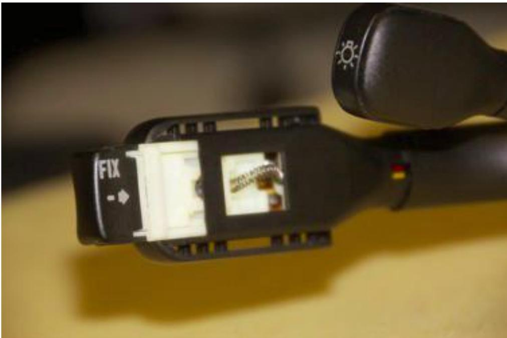
Man kann jetzt noch den Anschlussblock auf der Rückseite losschrauben, damit man etwas mehr Bewegungsfreiheit mit der Kabelage hat:
